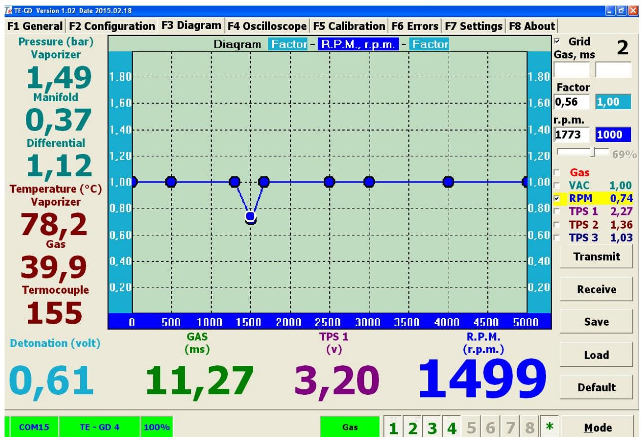
Запаздывание подачи газа, при резком нажатии на педаль акселератора, необходима для исключения кратковременной детонации. Регулируется цифровым фильтром. Чем больше число, тем большее задержка.
