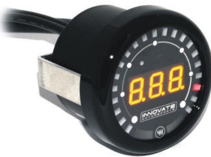
Индикатор MTX-L представляет собой измеритель соотношения воздух-кислород в выпускных газах двигателя. Работает в широком диапазоне значений соотношения от 7,35 до 22,39. Если в бензиновом двигателе это отношение определено довольно точно (14,7 для бензина), то в дизельном двигателе, работающем на бедных смесях, режим 14,7 является предельным для полного горения топлива. Именно эта информация и должна быть использована для настройки.
